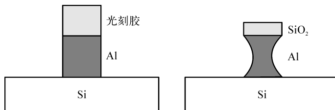
图 6-19 使用光刻胶和 SiO 2 为掩模的刻蚀示意图
